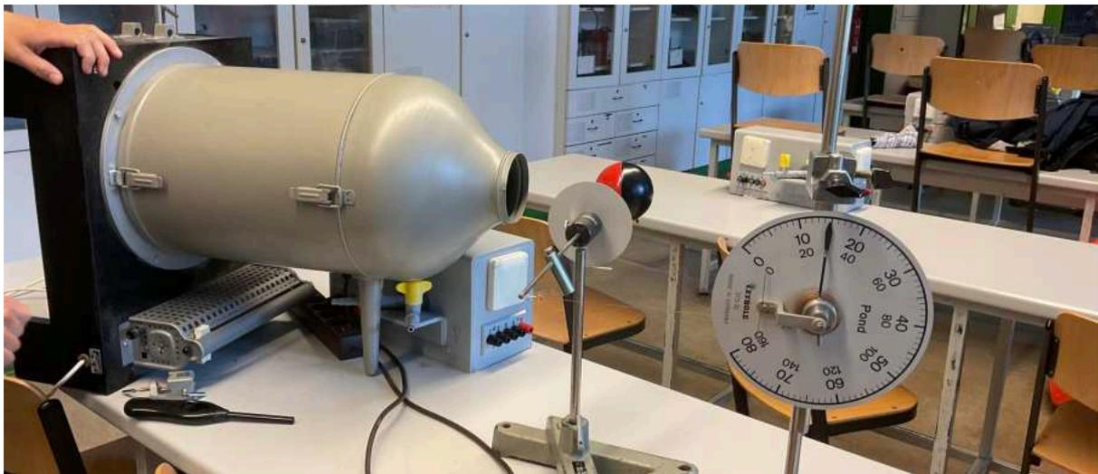
**W**as für den ein oder anderen vielleicht aussieht wie ein Teilchenbeschleuniger, ist in Wahrheit einfach nur eine Windturbine. Eine sehr laute. Die Windturbine in Kombination mit anderen Bauteilen soll dazu beitragen, den Luftwiderstand von verschiedenen Körpern zu messen. In dem Projekt geht es darum, physikalische Experimente zu vollziehen, die sonst so im normalen Unterricht nicht stattfinden. Ein Beispiel dafür wird in diesem Bericht behandelt.
