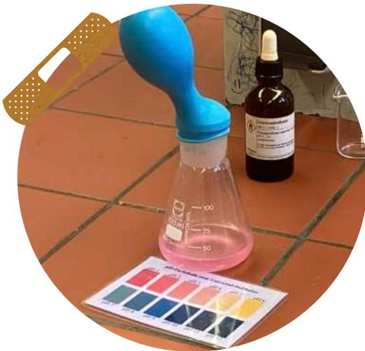
Der Kontakt von Tablette und Magensäure wird simuliert. Es entsteht CO<sub>2</sub>.
